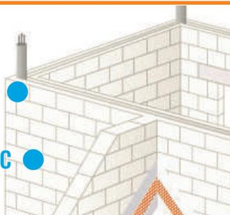
Esempio di posizionamento di irrigidimenti negli angoli dell'edificio.
