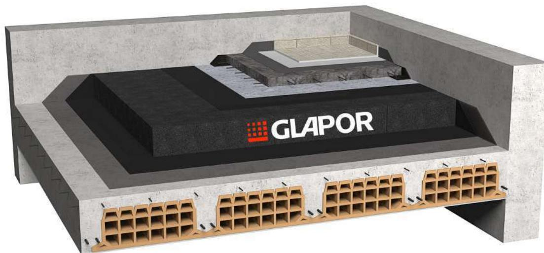
Stratigrafia isolamento tetto piano con pavimento calpestabile
